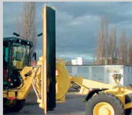
Drehkranz geschlossen, rollengelagert, Böschungswinkel 90° rechts und links
