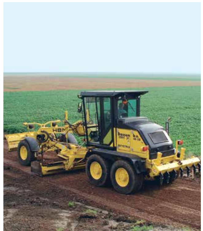
BG 110 TA-4, компактный тандем-грейдер, идеальная машина для маленьких и средних стройплощадок
